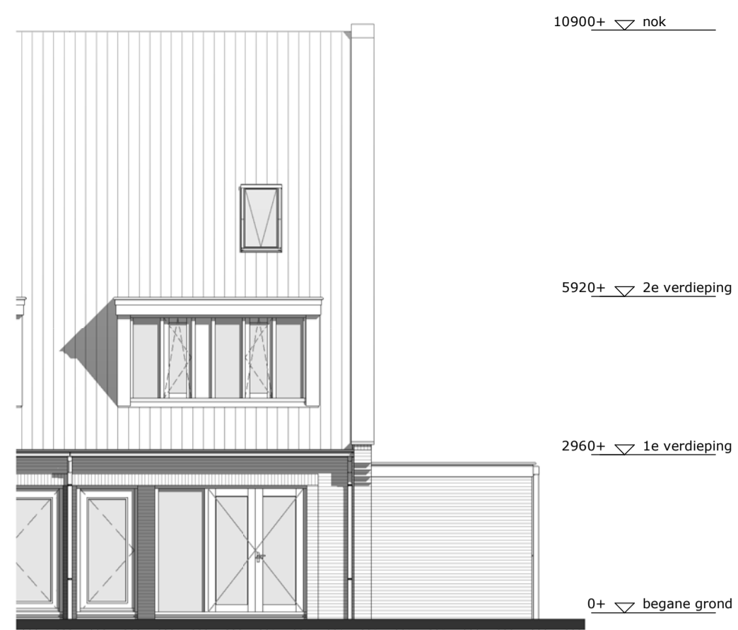
voorgevel 1 : 100 optie: dubbele deur
