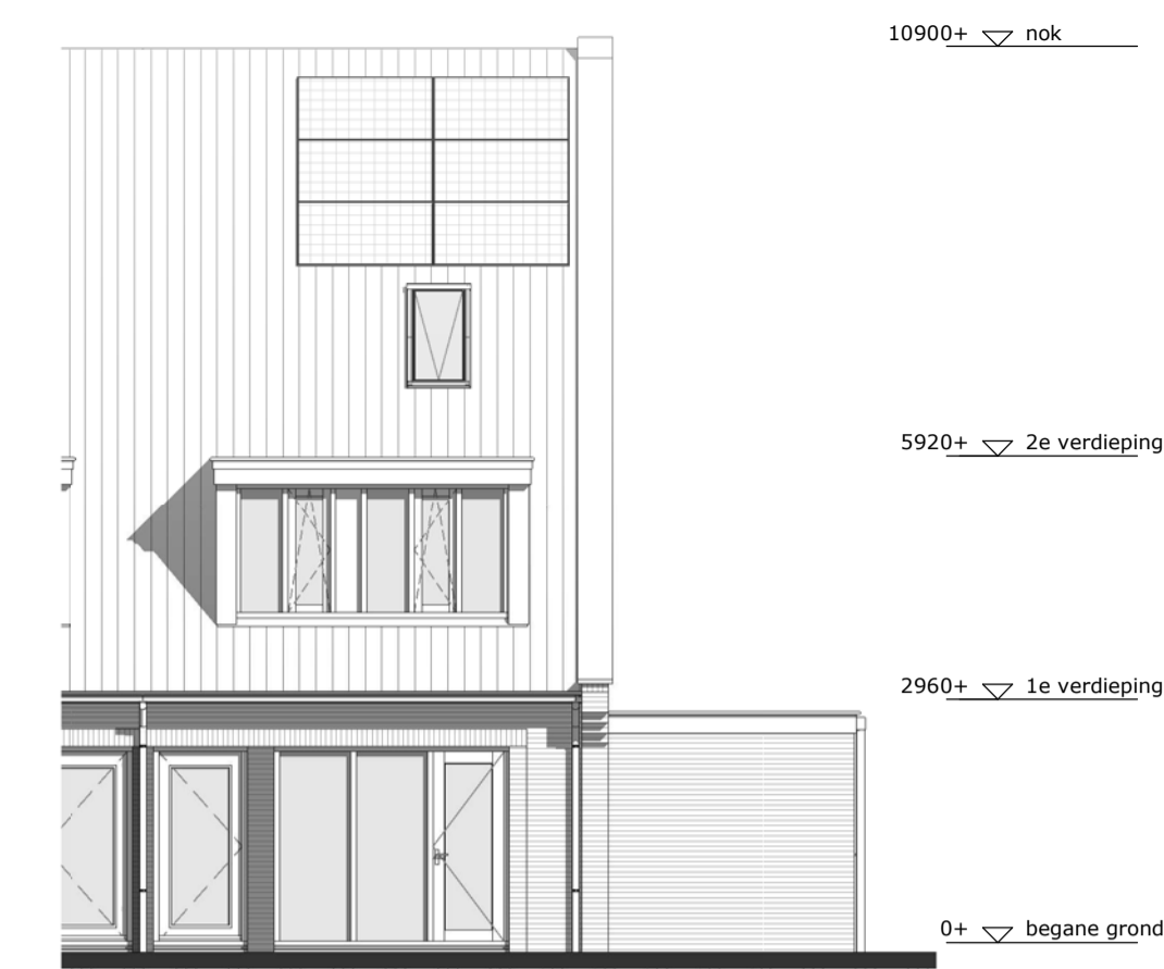
voorgevel 1 : 100 optie: zonnepanelen 6 stuks
